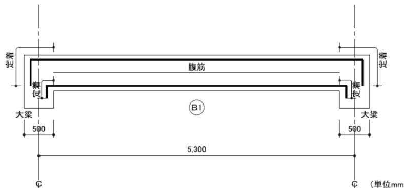
単独梁のD16以上の鉄筋の継手は、鉄筋の長さ7.00mごとに1か所である。
