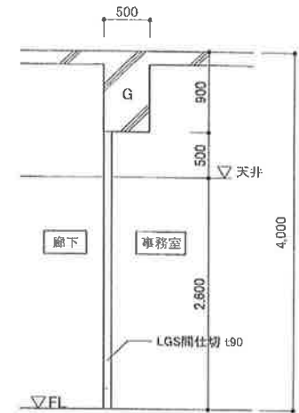
A-A LGS間仕切断面図
